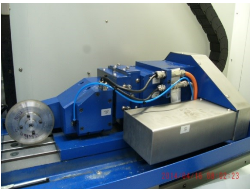
Schwenkabrichter mit Diamantrad, einseitig gelagert
