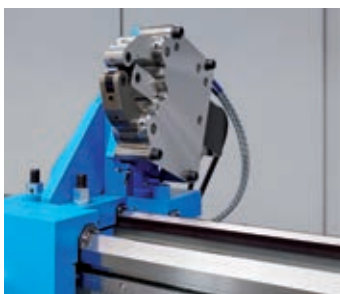
Hydraulische selbstzentrierende Lünette über Handkurbel positionierbar.
