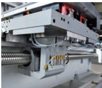
Hochwertige Kugellrollspindel mit großem Durchmesser für stabilen Lauf. Linearführungen in der X-Achse im Standard.
