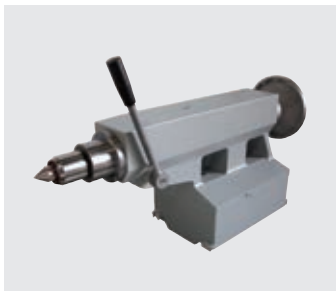
Stabiler Reitstock mit einer Pinole von D = 90 mm und einer Aufnahme MK 5.
