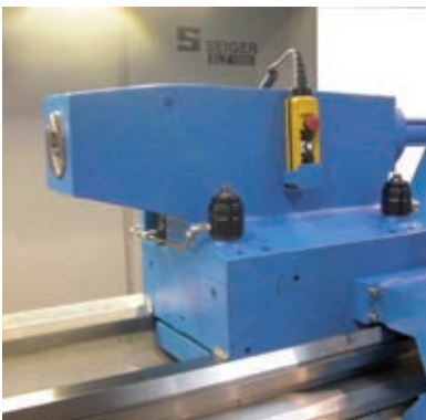
Elektrisch verfahrbarer Reitstock über Getriebe-motor und Zahnstange. Hier Ausführung mit hydraulischem Reitstock, hydraulischer Pinole und Klemmung auf dem Bett.
