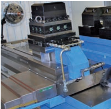
Bohrstangenklemmlager mit tauschbaren Lager-schalen für unterschied-liche Durchmesser. 2 Klemmstellen und Zusatzführung auf dem Bettschlitten. Aufbau hinter der Drehmitte.
