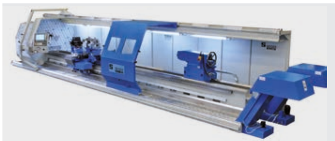
SLZ 850 E mit 8.000 mm Spitzenweite und Sonderaufbauten.
