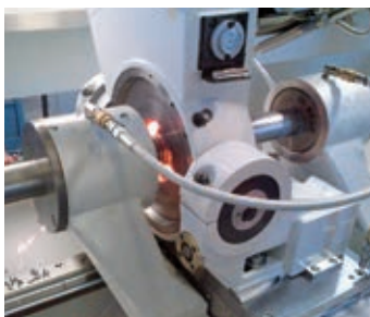
Stabiler kunststoffbeschichteter Support. Auf Kundenwunsch wurde ein Gewinde-wirbelgerät auf dem Support montiert.
