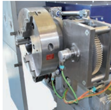
C-Achse und zweiter Futterflansch am Spindel-ende mit Spannfutter.
