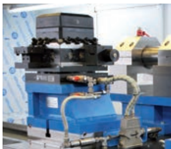
Stabiles Bohrstangenklemmlager mit zusätzlicher Linearführung über Nullpunktspannsystem auf dem Planschieber fixiert.
